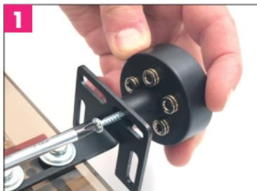
1. Coloque la pieza de conexión SLM (Art.290-29000), tienda los conductos de lubricación en los 5 puntos de lubricación (consulte nuestros accesorios en la página 26).
