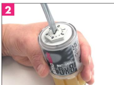
2. Ajuste el tiempo de dispensación (en meses) en el cabezal de accionamiento utilizando un destornillador o una moneda. Deduzca la cantidad de dispensación deseada de la tabla (p. 24).
