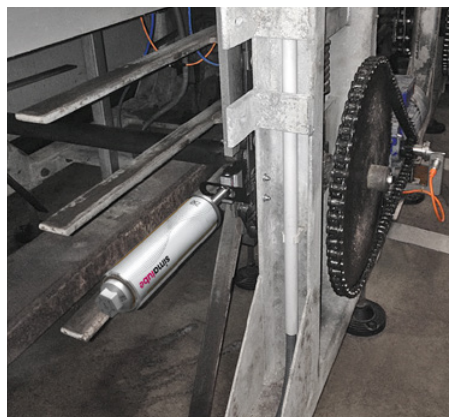
Het smeren van een ketting met een 250 ml simalube en een platte smeerborstel.
