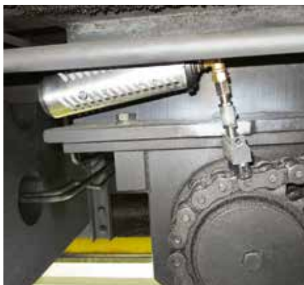
Het simalube 250ml patroon smeert de aandrijfketting van een spookraan. Een beschermkap beveiligt het patroon.
