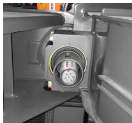
De koppeling van twee treinwagens wordt gesmeerd met een simalube 125 ml patroon.
