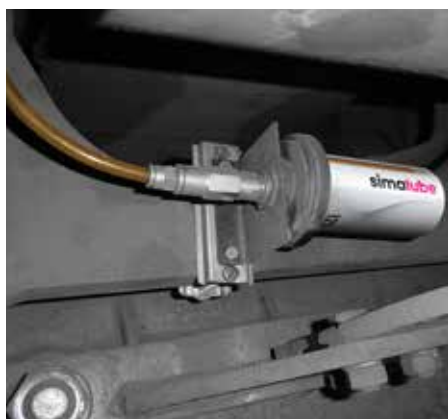
Het 125 ml patroon werd geïnstalleerd op het chassis van een lagevloertram. Het smeermiddel wordt via een slang naar het smeerpunt geleid.
