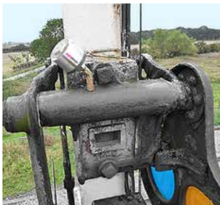
De glijlager van een spoorwegsein wordt automatisch en continu gesmeerd door een simalube 30 ml patroon.
