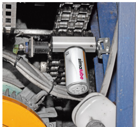
Het simalube smeerpatroon voorziet de ketting zelfs in kleine ruimtes continu van olie. Daarnaast reinigt de borstel de ketting.
