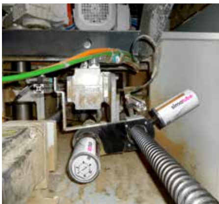
De spindel van een cirkelzaag wordt betrouwbaar gesmeerd door twee 125 smeerpatronen.
