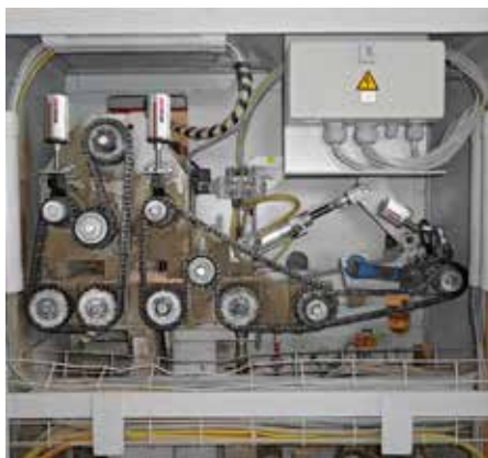
De kettingen van een afkortzaagmachine met rolvoer worden permanent gesmeerd door drie simalube smeerpatronen met borstels en worden gelijktijdig gereinigd.
