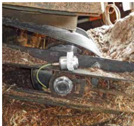
De Ykogellager van een transportband wordt continu voorzien van smeermiddel.
