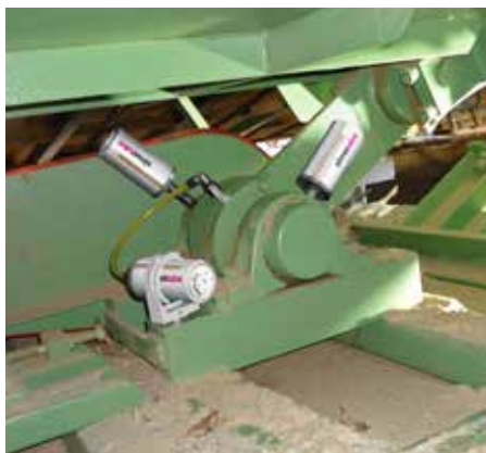
De lagers van een trilkanaal worden continu gesmeerd door drie smeerpatronen.
