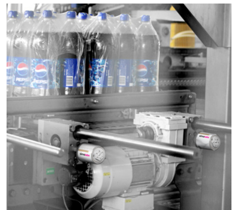
Het lager op een tandwielkast wordt gesmeerd met twee 60 ml simalube smeerpatronen.
