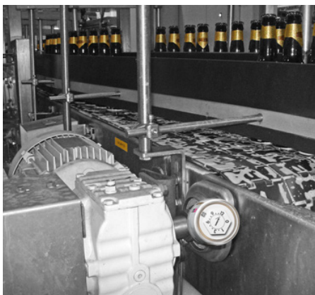
Smering van een transportband met een simalube smeerpatroon.
