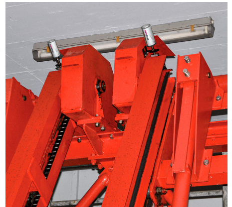
Kettingsmering bij een stappenrooster met simalube, uitgerust met borstel.
