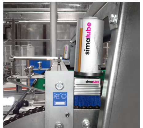
Die beiden simalube mit Bürste schmierer die Kette in einer Brauerei.
