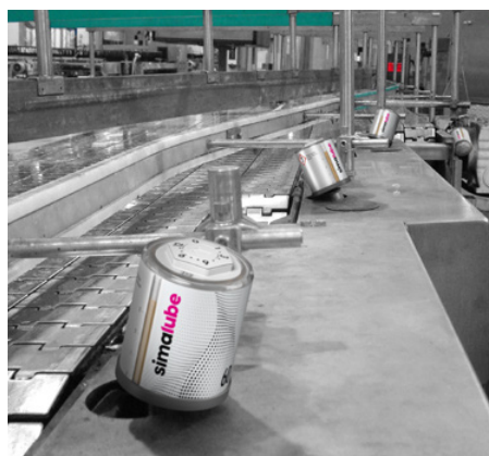
Ligne d'embouteillage dotée de plusieurs graisseurs simalube.
