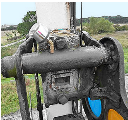
Le palier lisse d'une signalisation ferroviaire est graissé automatiquement et en continu par le graisseur simalube de 30 ml.
