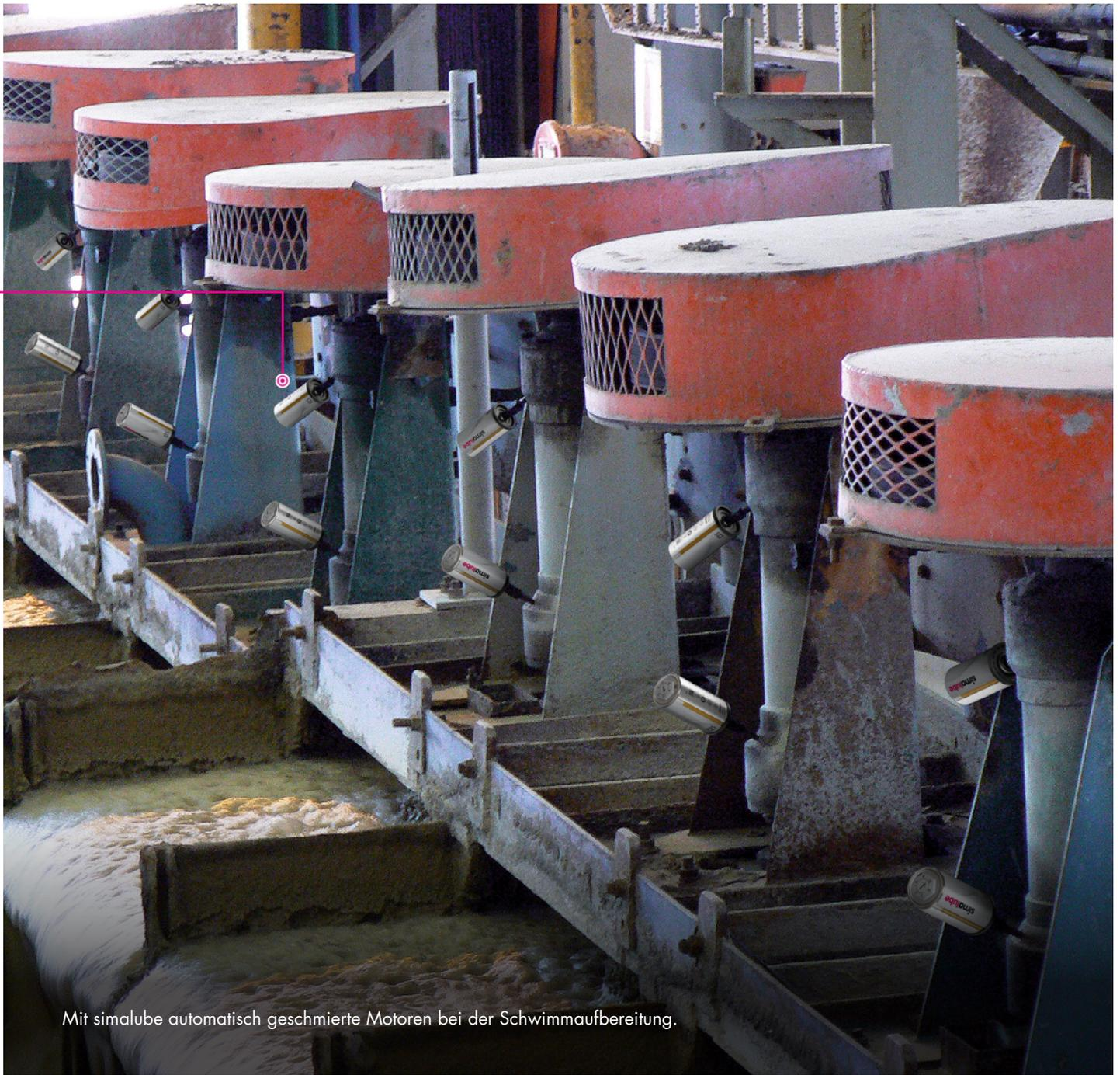
Mit simalube automatisch geschmierte Motoren bei der Schwimmaufbereitung.
