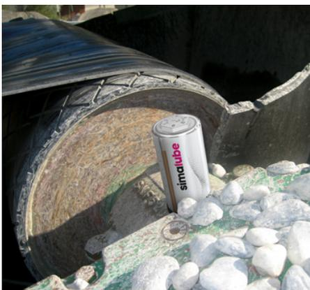
Ein mit simalube geschmierter Riemenantrieb.
