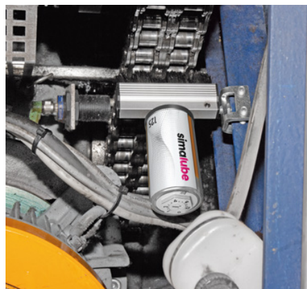
Der simulube Spender versorgt die Kette auch bei engsten Platzverhältnissen kontinuierlich mit Öl. Die Bürste reinigt gleichzeitig die Kette.
