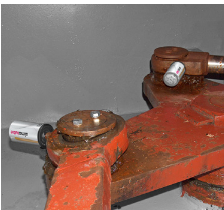
Das Ruderrad wird mit zwei 125 ml simulube geschmiert.
