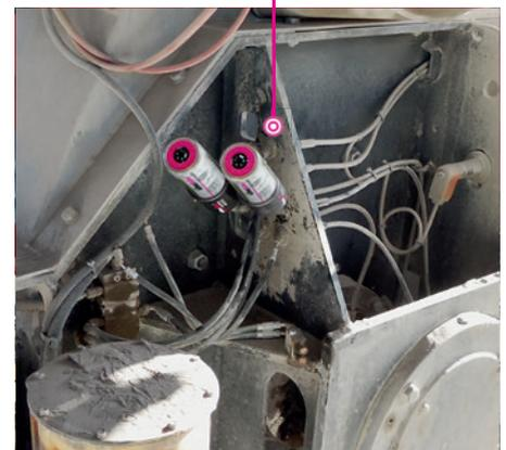
In einem Steinbruch überwinden zwei simalube IMPULSE Druckverstärker mühelos den Gegendruck zweier Lager.
