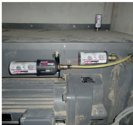
Der Schmierstoff wird über eine lange Leitung zur Schmierstelle geführt. Ein Montagewinkel mit zwei Magneten fixiert den simalube IMPULSE an der Anlage.
