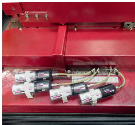
Vier simalube IMPULSE Druckverstärker schmieren mittels Schlauchverbindungen die Linearführungen einer CNC-Maschine.
