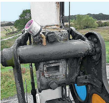
Das Gleitlager eines Eisenbahnsignals wird von einem 30 ml simalube Schmierstoffspender automatisch und kontinuierlich geschmiert.
