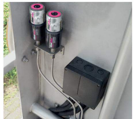
Deux simalube IMPULSE sont utilisés sur la base des conduites de graissage installées en permanence sur un racleur de réservoir. Ils surmontent la contre-pression et assurent une lubrification continue.
