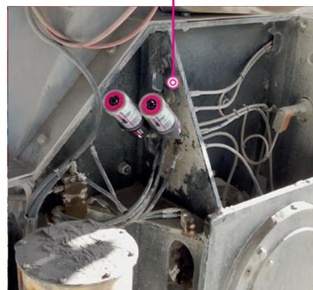
Dans une carrière, deux amplificateurs de pression simalube IMPULSE surmontent sans effort la contre-pression de deux paliers.
