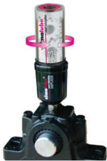
Replace or refill the empty lubricator
